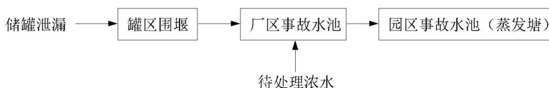
图 6 本项目事故废水防控体系示意图
